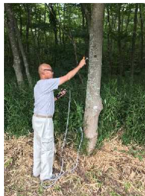
写真-1 応力波伝播速度測定状況
