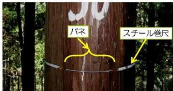
写真2 胸高直径成長量を測定する成長バンド
