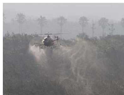
写真2 無人ヘリコプターを用いた薬剤散布
