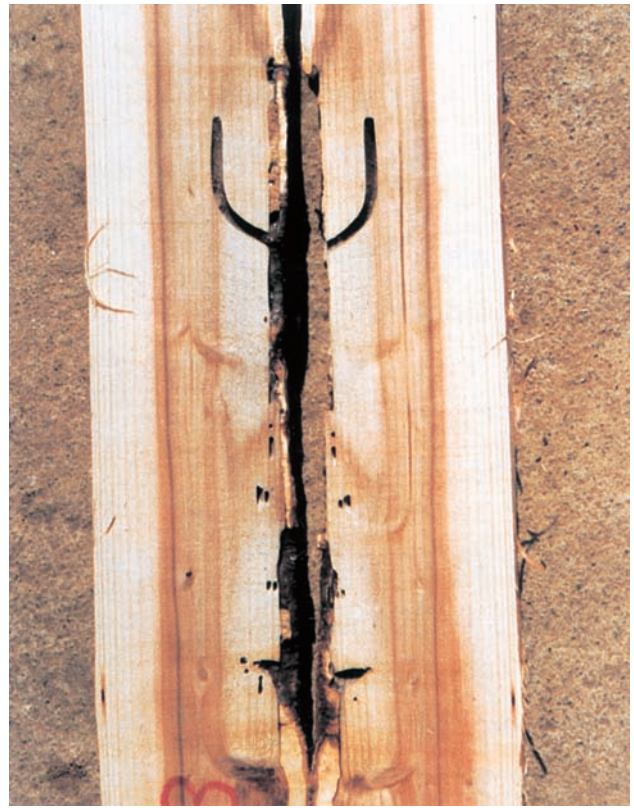
写真 - 7 材内の蛹室と腐朽部分 (左の材を二つに割って開いたところ)
