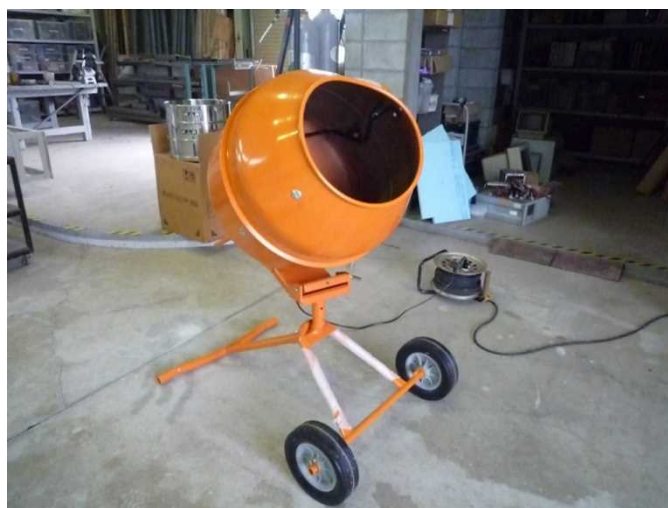
図 6.2.2.3-1 試験に用いたコンクリートミキサー
