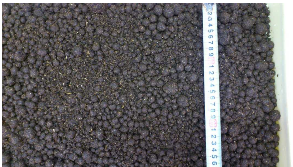
図 6.3-1 回収 CSH スラリーを用いて製造された豚ふん造粒堆肥
