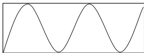
※図A～Dの音の測定結果の画面は、0.05秒間のモノコードの弦の振動を記録したものの。画面の縦軸は振動の振れ幅（振幅）、横軸は時間を表している。
