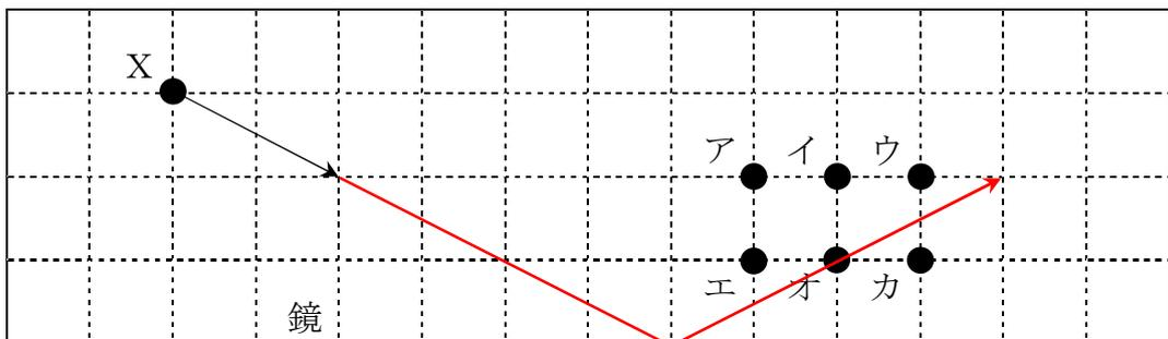
※入射角と反射角が等しくなるように反射する。
