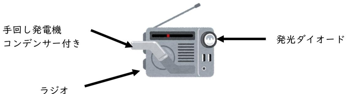
(発電) 電池がなくても手回し発電機によって、電気を発電しコンデンサーにためることができる。
