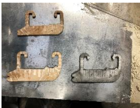
写真9 溶かした金属を流し込み製作したネコバッグサポーター
