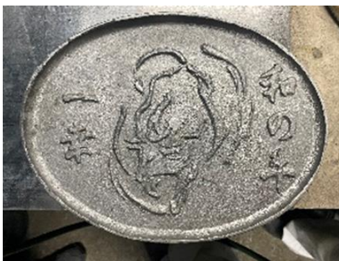
写真10 溶かした金属を流し込み製作したオリジナルステーキプレート
