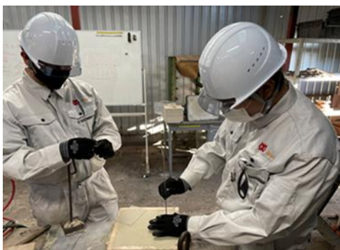
写真8 砂型製作の様子
