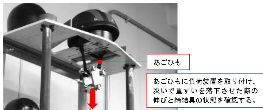
写真 2. 保持装置の強さ試験の様子
