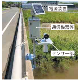
河川の水位を自動で計測する危機管理型水位計
