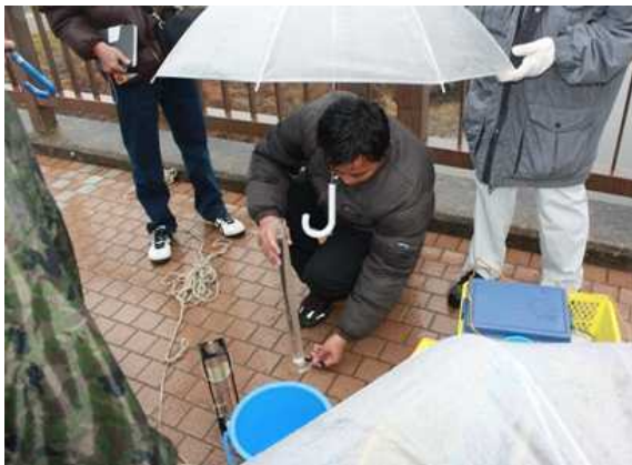
採取した河川水の透視度を測定
