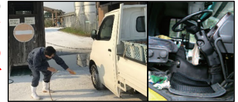
車両はタイヤだけでなく、 泥よけの内側まで消毒 し、 フロアマットの交換 や ペダル等車内も消毒
