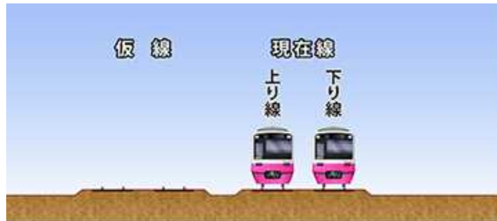
① 2線分の仮線用地を確保し仮線を敷設
