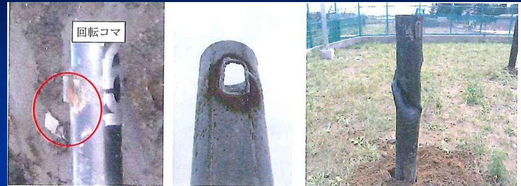
写真9 回転コマの損傷, 過大なトルクによる損傷
