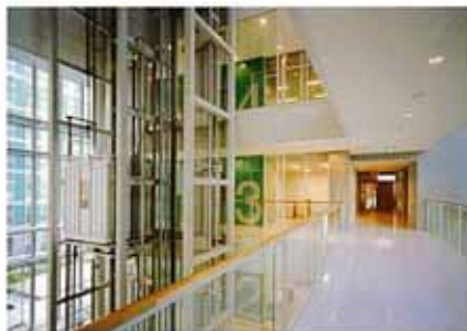
頂部にベンチレーターを配した自然換気の要のアトリウム
