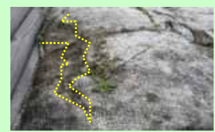
試験開始6ヵ月後(H21年9月)から土嚢袋の破けが見え始める
