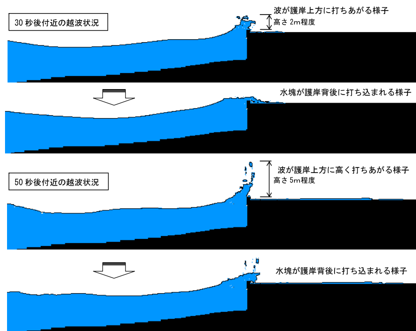
図8 数値シミュレーションによる越波再現状況
