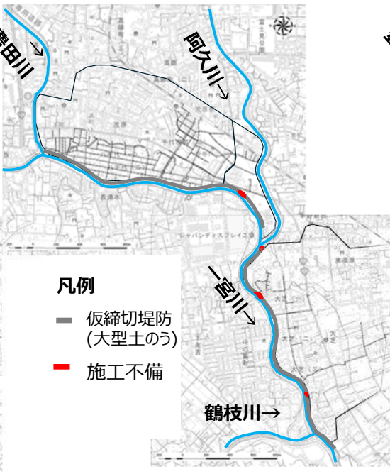
② 仮締切堤防に施工不備があるも、変状は無かった場合
