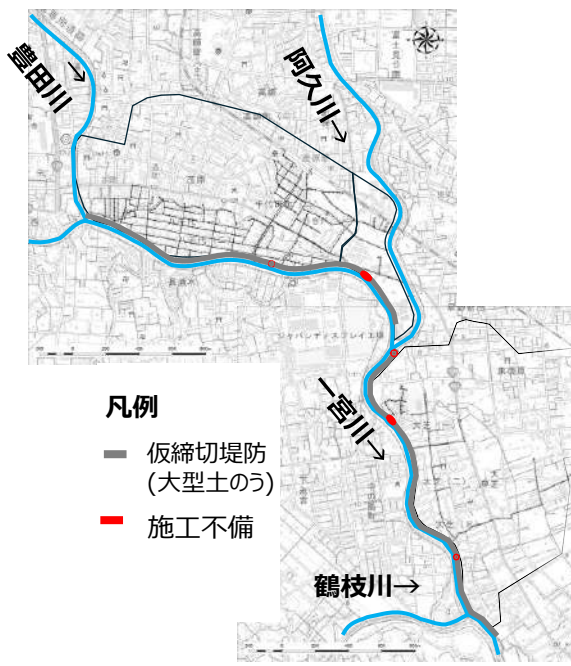
② 仮締切堤防に施工不備があるも、 変状は無かった場合
