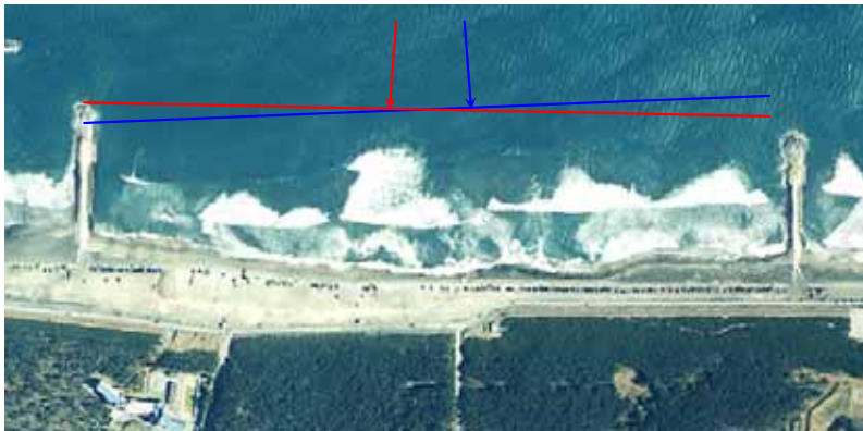
突堤間の海岸線がほぼ直線(砕波帯も直線) = 入射波向で海岸線が変形 不安定
