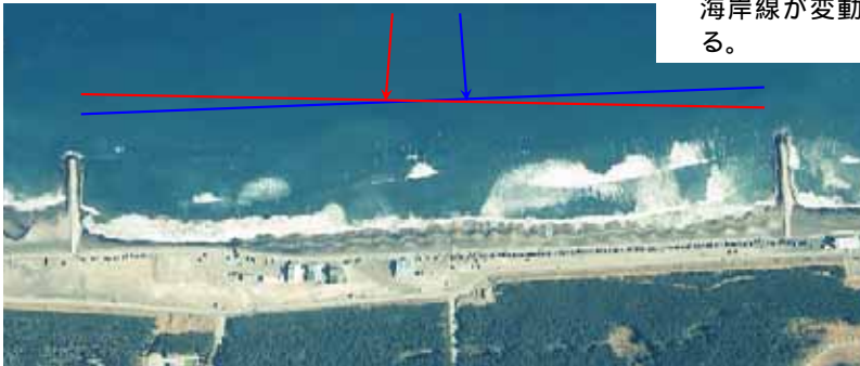
突堤間の海岸線が直線(砕波帯も直線) = 入射波向で海岸線が変形 不安定
