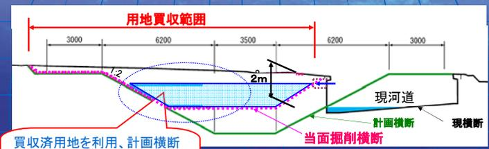
買収済用地を利用、計画横断の範囲内を掘削し、洪水を貯留する。V=約800m<sup>3</sup>(試算値)
