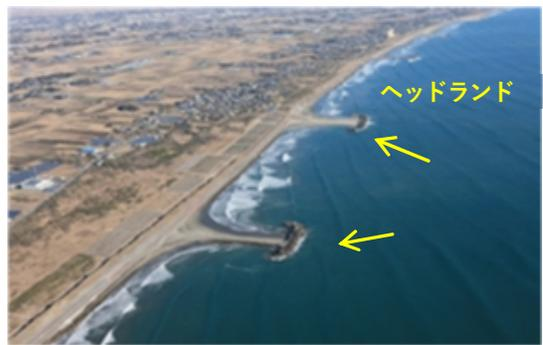
ヘッドランド: コンクリートブロックを用いて、岬間から沿岸方向に流出する砂を制御することで、砂浜の安定を図る。
