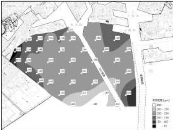
図 II.3.3 中央粒径の分布の変化
