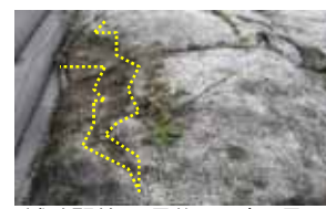
試験開始6ヵ月後(H21年9月)から土嚢袋の破けが見え始める
