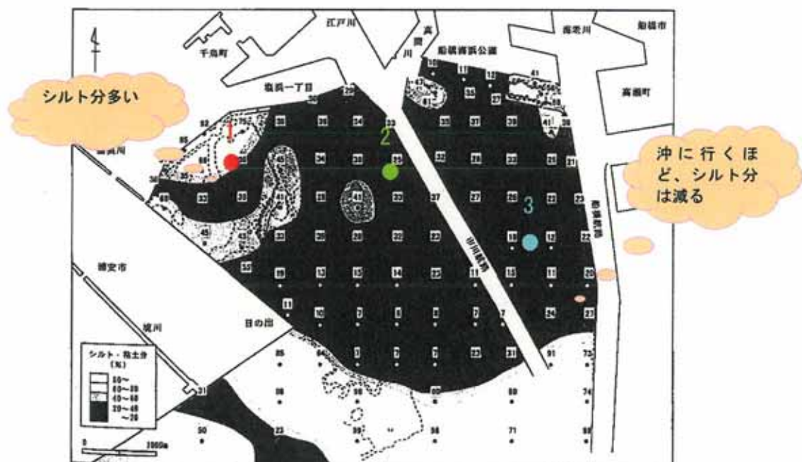
図 3.1.2 (2) 底質のシルト・粘土分の水平分布（夏季：8月調査）
