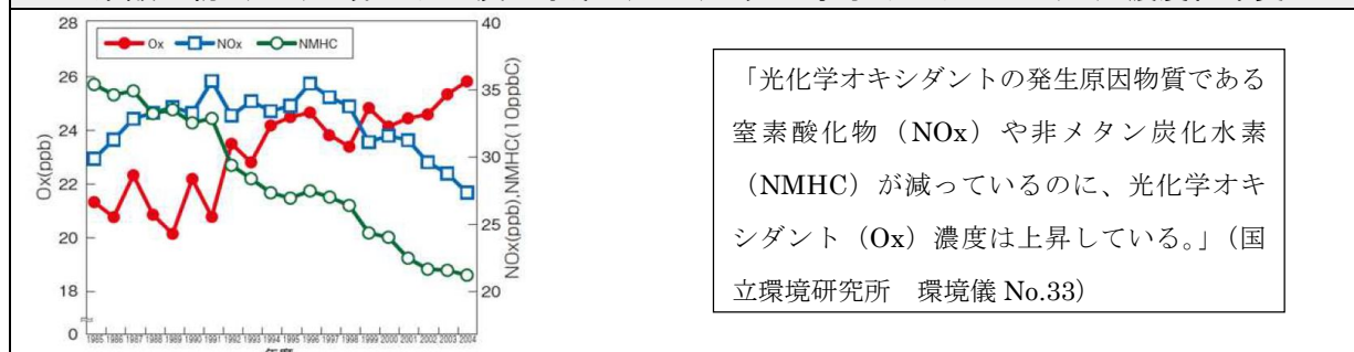
窒素酸化物 (NOx)・非メタン炭化水素 (NMHC)・光化学オキシダント (Ox) 濃度経年変化
