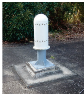
モニタリングポスト (館山亀ヶ原測定局)
