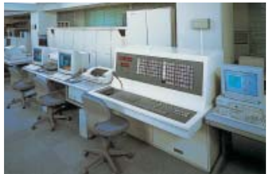
【大気情報管理システム】 大気環境及び主要工場の排出状況を常時監視し、光化学スモッグの緊急時対策など、大気に関する情報を管理し、複雑多様化する大気環境の保全に対処できるシステムとなっています。
