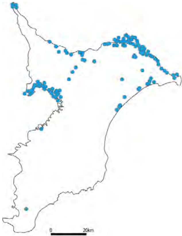
図表 4-4-8 東日本大震災による液状化―流動化現象発生地点
