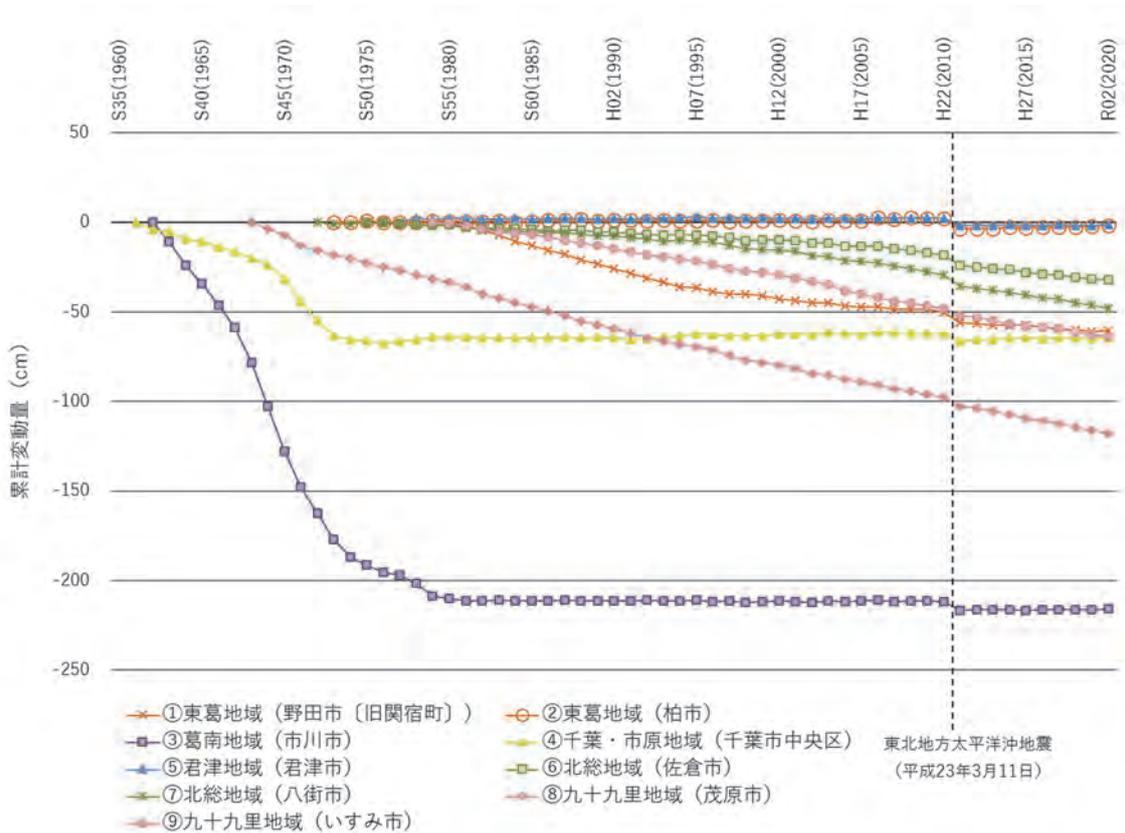
図表 5-3-2 5年間累計の地盤沈下状況（5年間累計沈下量）
