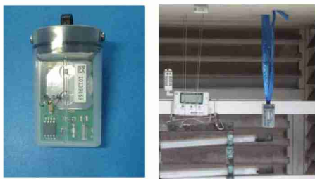
写真2 新温度計:高さ58mm × 幅33mm × 厚さ23mm、重さ18g
