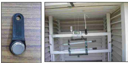
写真1 旧温度計:直径17mm × 厚さ6mm、重さ3.3g
