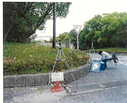
例) 騒音調査の状況
