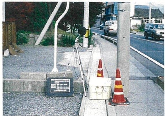
例) 騒音調査の状況
