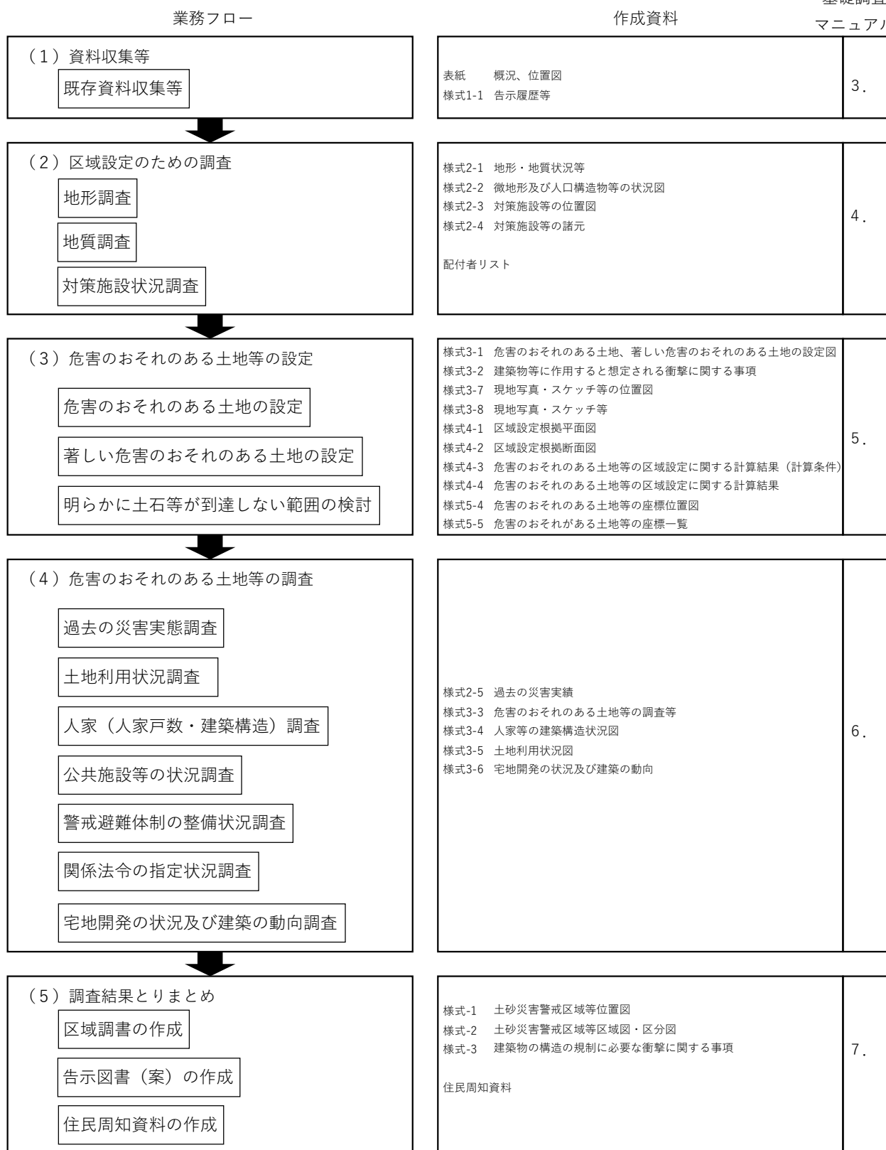
図 2. 1. 1 基礎調査の流れ
