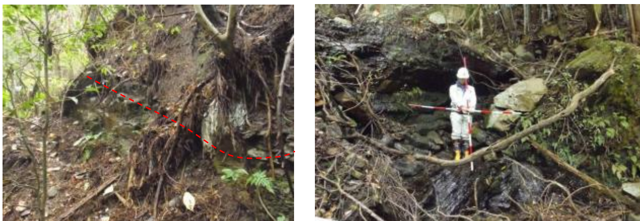
図 4.5-3 地滑り地の基盤を構成する地質の確認状況（地滑り区域外で確認）
