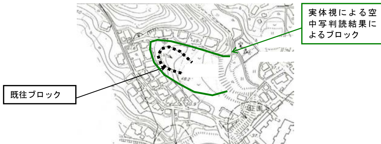
図 4.4-2 実体視による空中写真再判読結果による地滑りブロックの見直し事例
