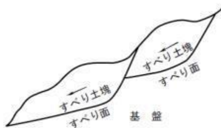
図 4.6-8 階段型すべり面
