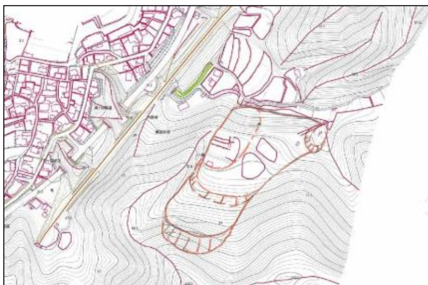
図 6.3-2 地滑りブロックの仮設定
