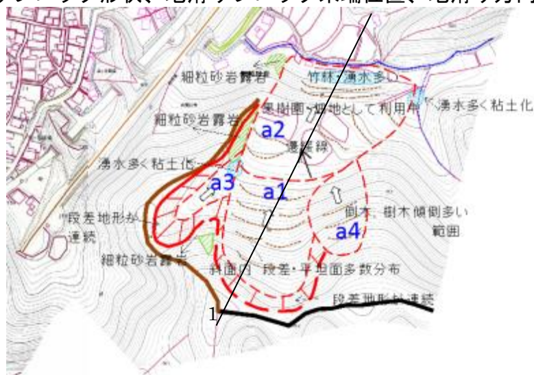
図 6.3-5 地滑りブロック形状、地滑りブロック末端位置、地滑り方向の設定事例
