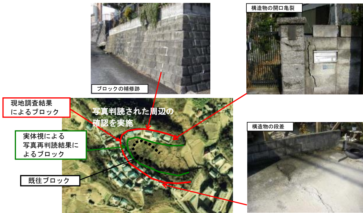
図 4.4-3 現地調査によって活動性が高いと判断される範囲を新たに確認した事例
