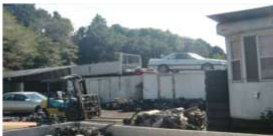
囲いの一部にコンテナを使用しているヤード
