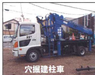
SST打設機械
