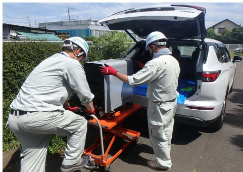
電動車両への可搬型蓄電池の積載
