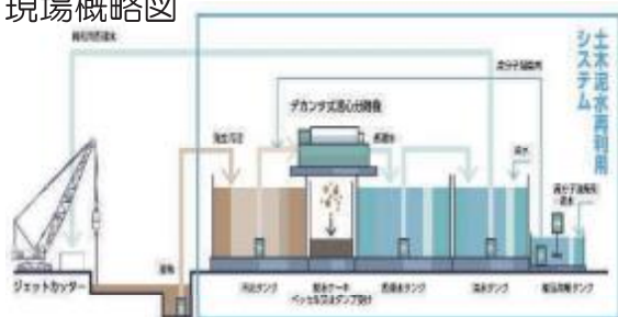
ウォータージェット併用法の様子。発生した大量の汚泥をポンプで吸い上げる。ポンプで吸い上げた汚泥を泥土と水に分離。処理水は再利用。
