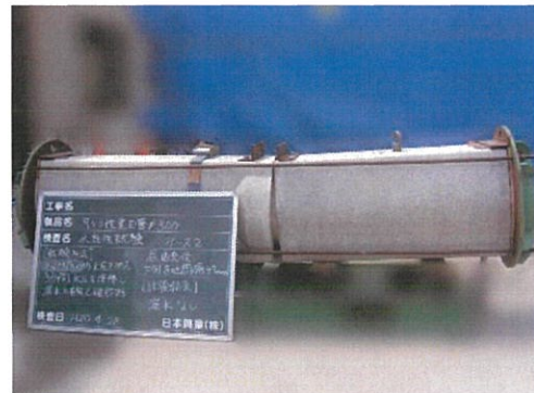
【水密試験】 重圧管の内側に0.1MPaの水圧を加え 3分間保持した後、漏水なし
