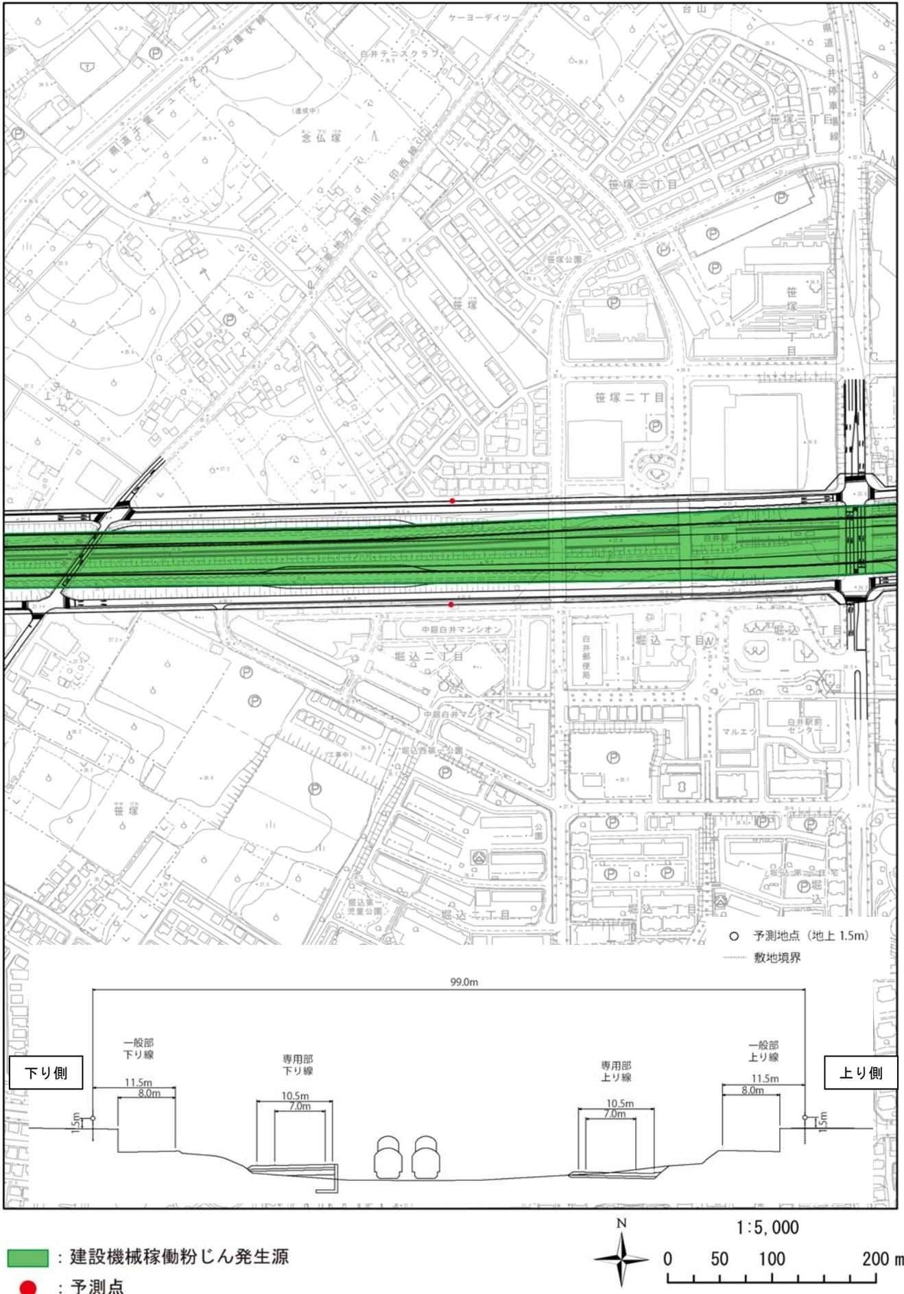
図 2.4-1(13) 建設機械の稼働に係る粉じん等のユニット配置図
