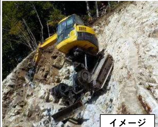
高所法面掘削機による作業を予定
