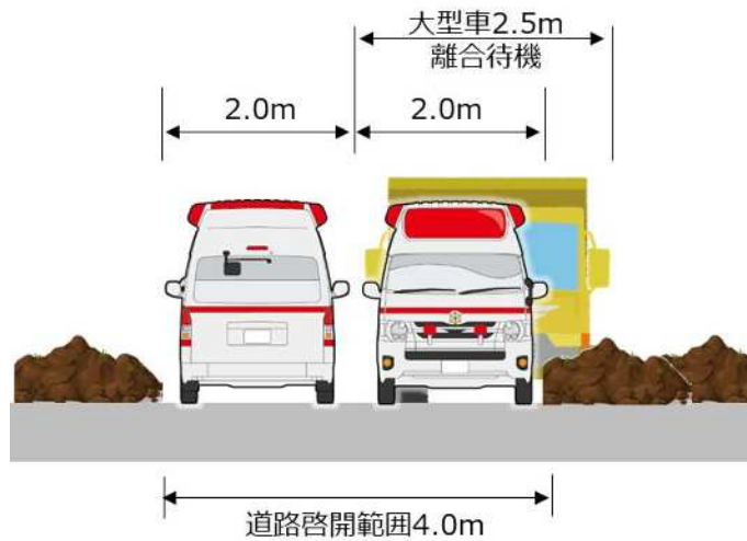
図 3.3 最小啓開幅員イメージ
