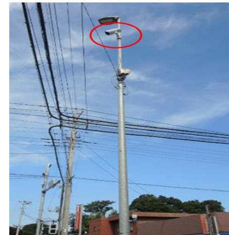
照明灯等にカメラを設置し、交通状況を取得 AI画像解析ソフトを活用し、取得したデータから交通量や交通流動を把握
