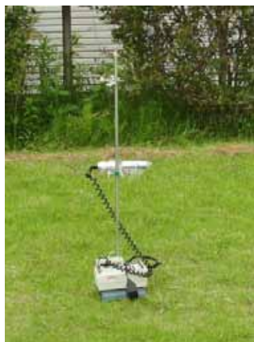
写真 3-8-4 空間放射線量測定器 (サーベイメータ)
