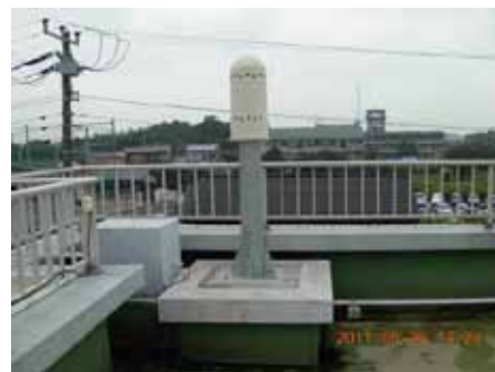
写真 3-8-2 旭市に設置した モニタリングポスト
