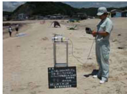
写真 3-8-6 砂浜の空間線量率の測定
