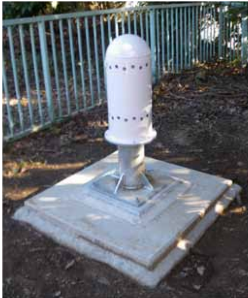
写真 3-8-3 印西市に設置したモニタリングポスト ※地上1mの高さに設置
