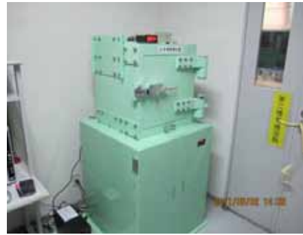
写真 3-8-5 放射能の測定装置 (ゲルマニウム半導体検出器)
