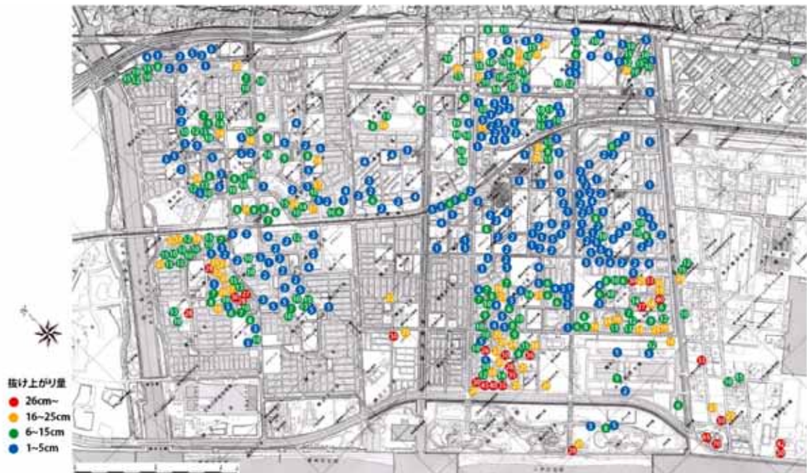
図 2-3-8 千葉市美浜区の花見川～黒砂水路における基礎構造物の「抜け上がり」量（≒表層の沈下量）
