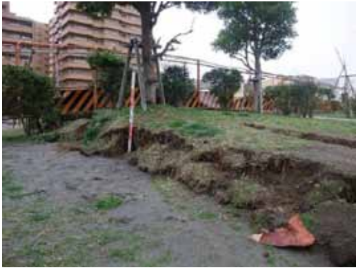
写真 2-3-14 浦安市明海 落差 40cm ほどの直線上の断裂が認められた 断裂の上盤側は変形も小さいが、下盤側（北西方向）は著しい液状化現象が認められる この断裂は約 1km にわたって追跡できる（3 月下旬）
