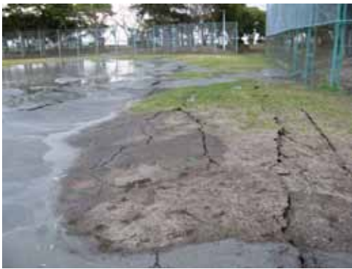
写真 2-3-10 千葉市美浜区高浜 稲毛海浜公園芝生公園での非常に大規模な噴砂群と沈下 千葉県東方沖地震では小規模な噴砂があった (3/12)
