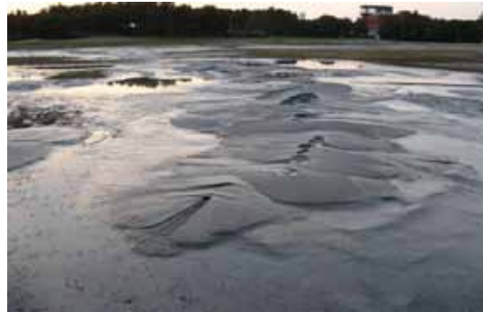
写真 2-3-10 千葉市美浜区高浜 稲毛海浜公園芝生公園での非常に大規模な噴砂群と沈下 千葉県東方沖地震では小規模な噴砂があった (3/12)
