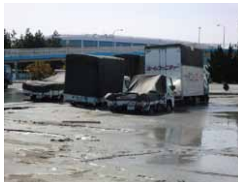
写真 2-1-31 メッセ駐車場の液状化
