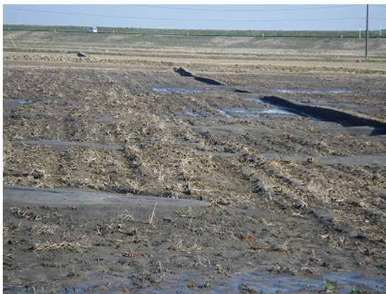
写真 2-3-23 香取市石納 波打った畦と噴砂。平行な亀裂が走りそこから砂の噴出がみられる (3/19)
