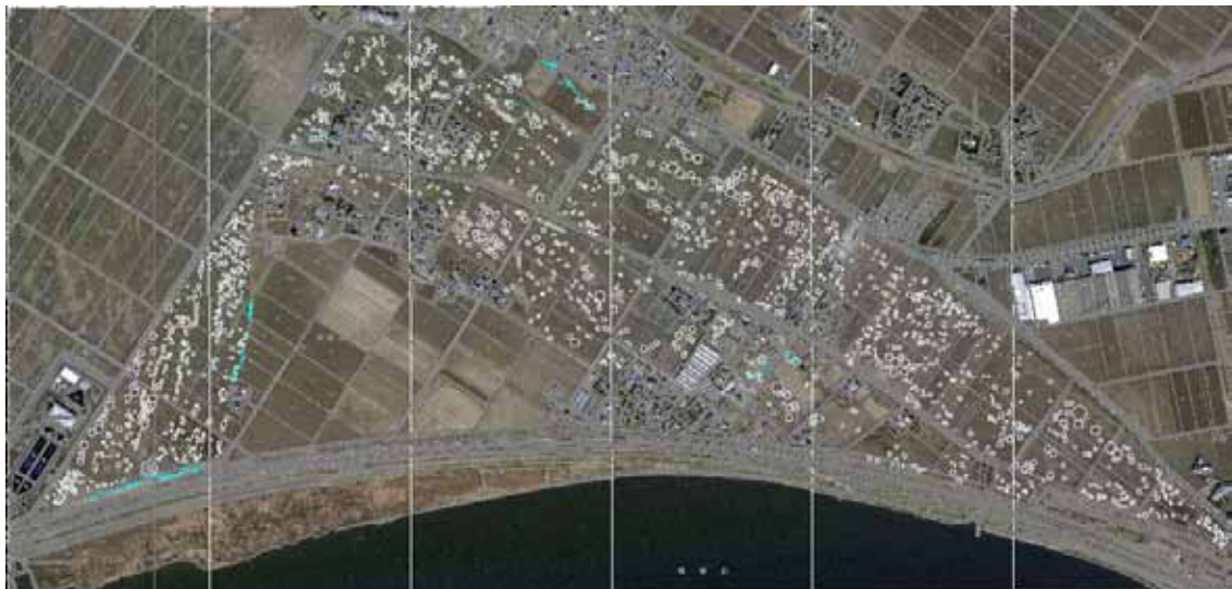
写真 2-3-30 石納・野間谷原地区（香取市・茨城県稲敷市）の衛星写真による液状化状況確認 （震災直後に公開されたグーグルマップを県で加工。白色の円は噴砂の箇所、水色の線は地割れ箇所）
