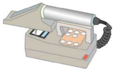
ZnS シンチレーション式 (アルファ線の測定)
