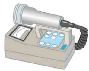
GM 計数管式 (ベータ線の測定)
