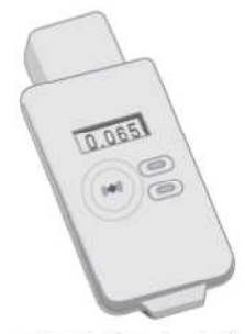
CsI シンチレーション式 (主に低線量の測定)
