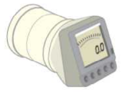
電離箱式 (低～高線量の測定)
