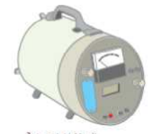
3 He 計数管式 (中性子線の測定)
