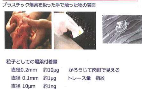
図-4 ●トレース探知の1例; 爆発物に触った場合;トレース探知:
