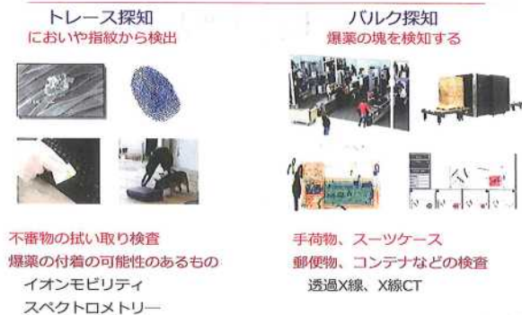
図-3 (1)爆発物探知技術・器材の1例; ア、トレース探知とバルク探知
