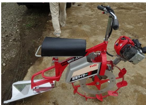
写真1 田面溝切機（乗用型）
