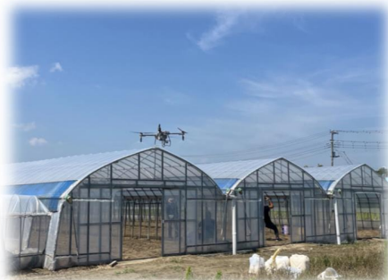
ドローンによる遮熱材の塗布
